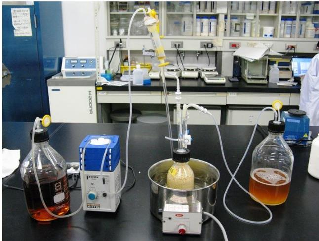
図 6. 乳酸菌 (*L. plantarum* ML11-11) と酵母 (*S. cerevisiae* BY4741) の複合バイオフィームを用いた連続発酵試験リアクター。
