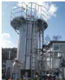
サッポロビールでは、ビール製造で培った発酵技術を活かし、食品廃棄物や農業残渣（ざんさ）を原料として、次世代のクリーンエネルギーとして注目される「水素」の発酵生産技術開発に取り組んでいます。現在、水素エネルギー利用の実用化に向けたパイロットプラントでのフィールド試験を国内製パン工場やブラジルで進めています。
