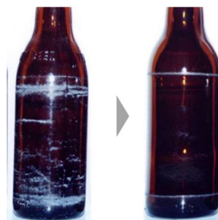
②びんの胴部の擦傷の状態 現在のびんは、白化する範囲が限定的
