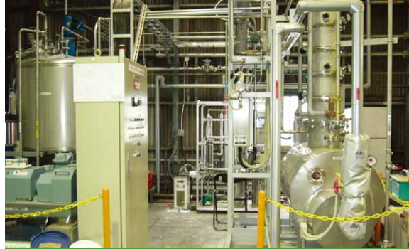
静岡油化工業(株)の小型バイオエタノールプラントと原料のオカラ
