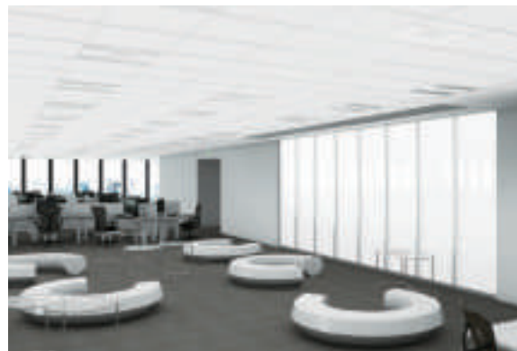
事務室内の壁面に設けられた約8m×1mの吹き抜け空間を通じて、窓からの光が届かないエリアにも自然光を届けます。また、自然換気装置によって事務室内に流入した外気を、排気する機能も担っています。
